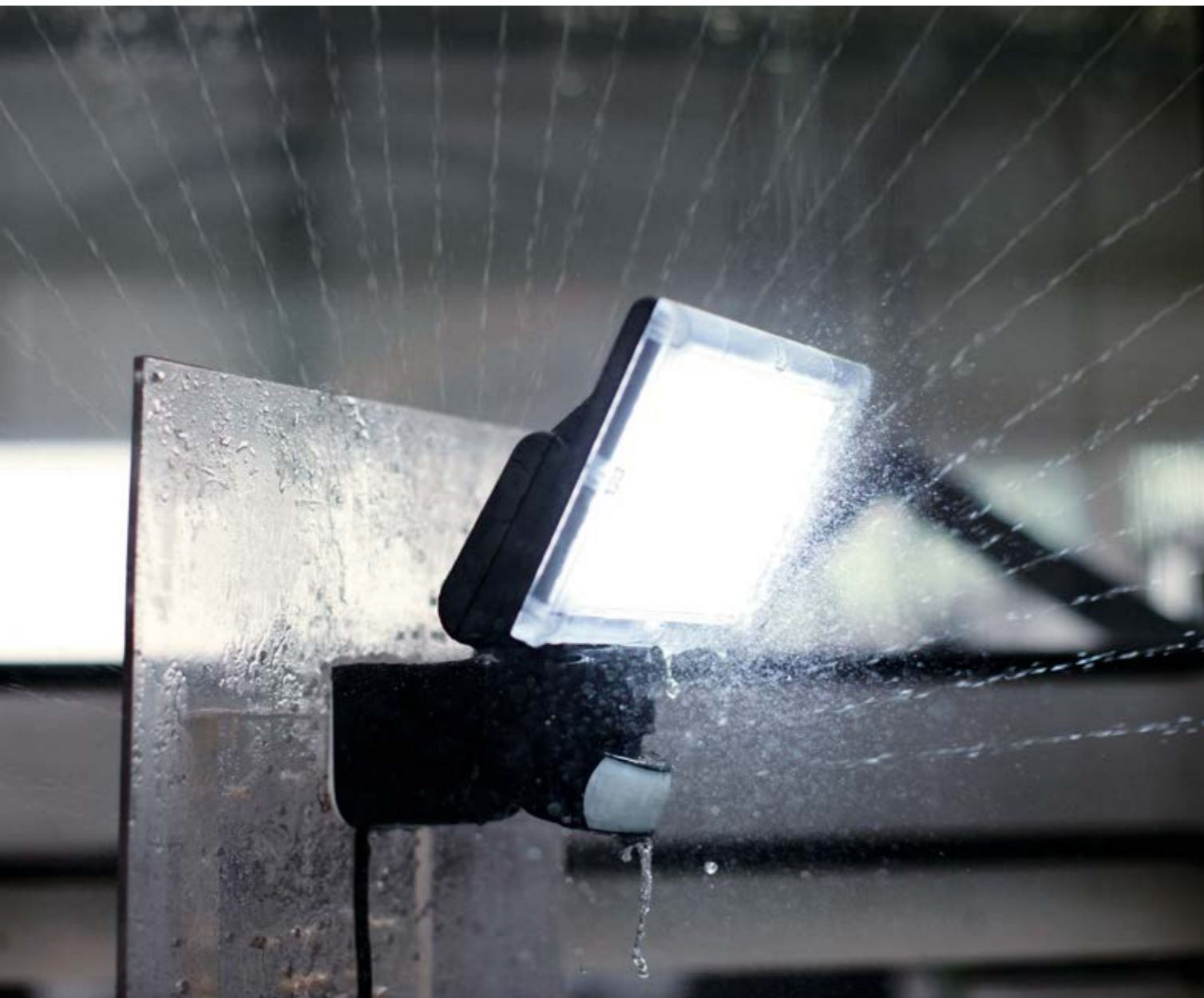
XLED home 1 w teście szczelności: badanie wodoszczelności gwarantuje odporność na wpływy atmosferyczne i stopień ochrony IP44.
